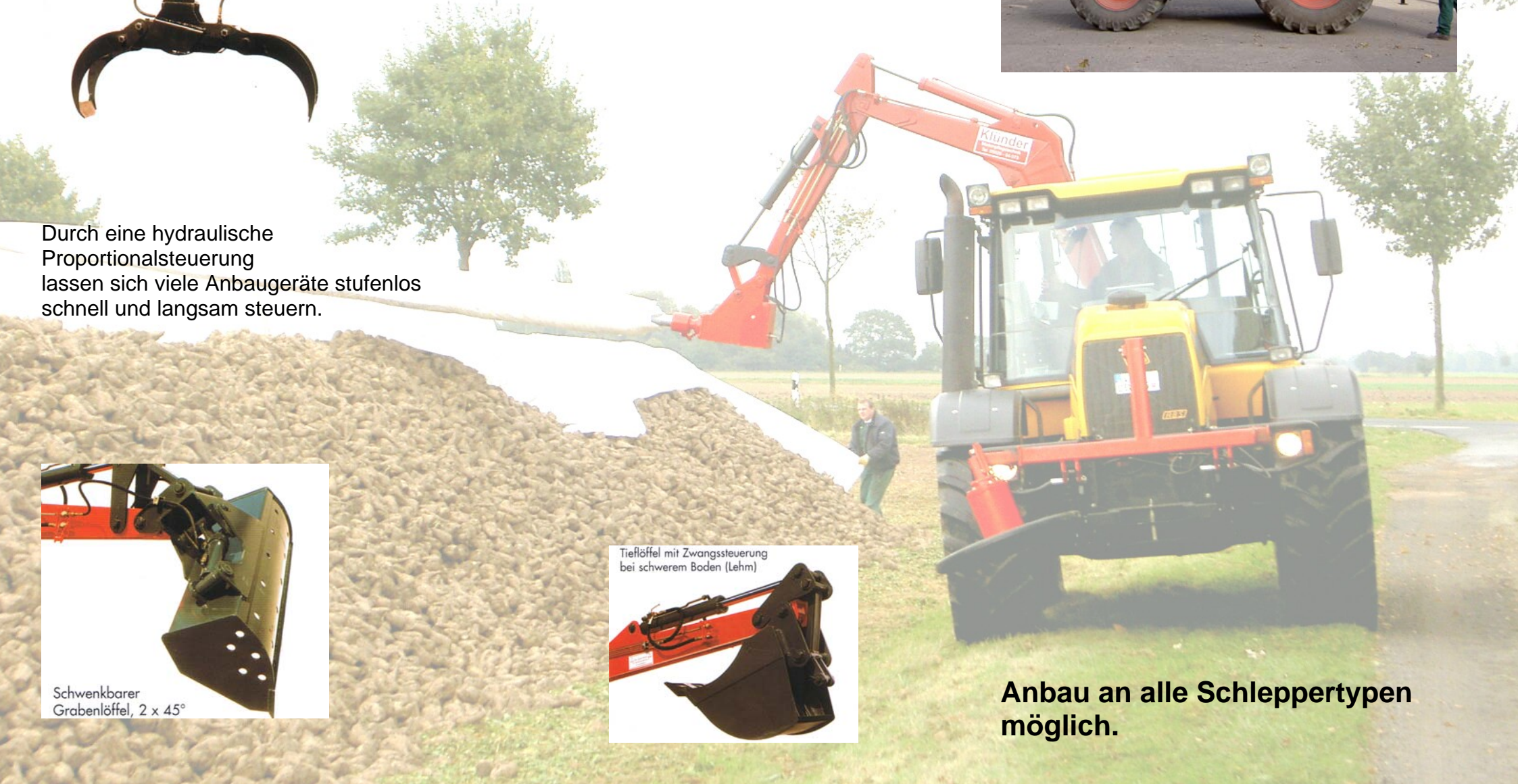
Holzzange (Zangenöffnung 1290mm)
